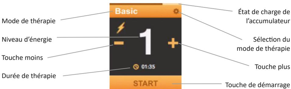
Lorsque le symbole éclair apparaît sous le programme de thérapie, l'énergie de sortie se situe aux électrodes.
