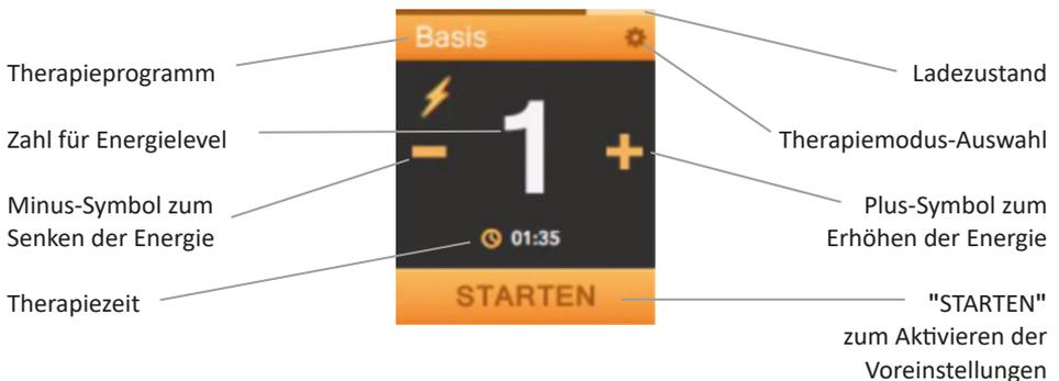
Wenn das Blitzsymbol unter dem Therapieprogramm erscheint, liegt die Ausgangsenergie an den Elektroden an.
